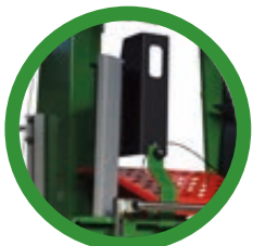
Seitliche, auf Kugellager montierte Beschickungsvorrichtung, mit senkrechter Ruheposition für den sicheren Transport
