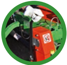
Notbremsvorrichtung des Sägeblattes für Maschinen mit Zapfwellenantrieb
