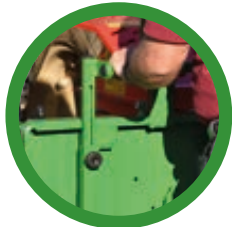
Griffhöhenverstellung für die Bedienung der Wippe
