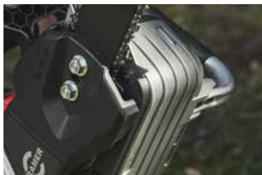
Robustes unteres Gehäuse aus Magnesium für zusätzliche Beständigkeit (82CS34).
